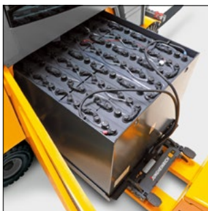
Sāniska akumulatora nomaīņa
