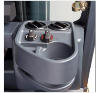
Apsildes sistēma, ieskaitot siltā gaisa sprauslas priekšējā stikla apsildei
