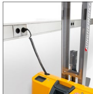
Pateicoties iebūvētajam lādētājam, vienkārša uzlāde pie jebkuras 230 V tīkla kontaktligzdas
