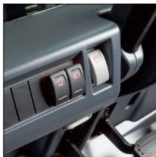
Vienkārši darbināma elektriskā stāvbremze, nospiežot pogu
