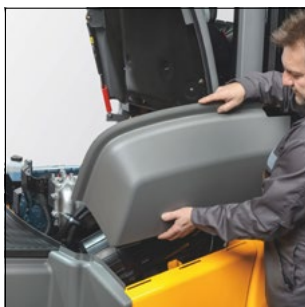
Bez instrumentiem vienkārši noņemamas sānu daļas
