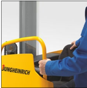
Rokturis drošai uzkāpšanai un kā montāžas palīgs, uzstādot dažādos pēc izvēles pieejamos aprīkojumus
